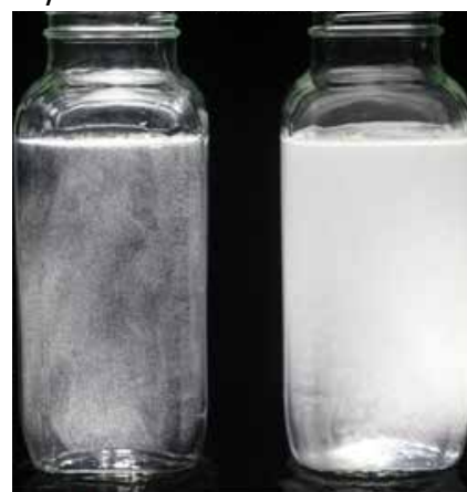
Herkömmliche Sprühtrocknung Elektrostatische Sprühtrocknung
